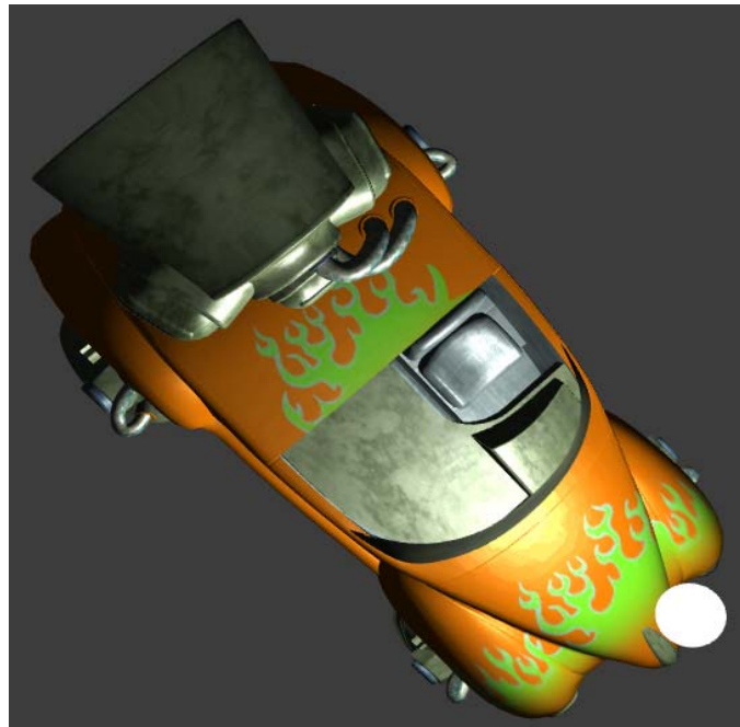
Figure 10. Réflexion spéculaire par bandes. Remarquez la qualité médiocre de la réflexion spéculaire du capot, artéfact (pastille blanche) compris. C'est la conséquence directe d'un manque de précision lors des calculs.
