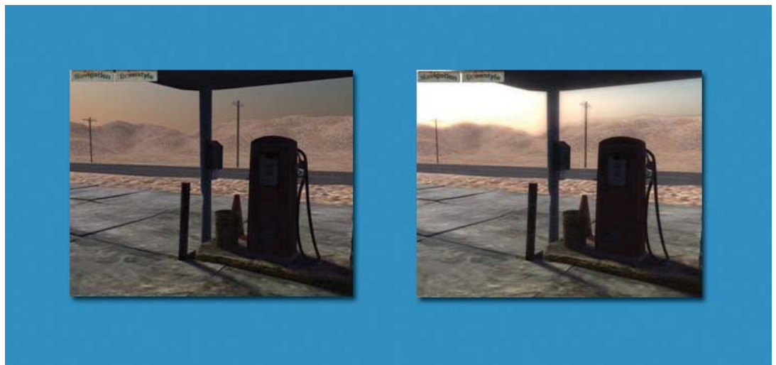
Figure 6. Tampon normal d'une scène non-éclairée (à gche), et scène éclairée résultant de l'emploi d'un tampon normal et d'un tampon de profondeur (à dte).
